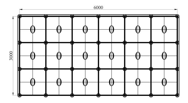
Schemat montażu stelaża SW-6x3 Assembly plan of steel galvanized mat grid SW-6x3
