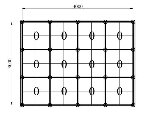
Schemat montażu stelaża SW-5x3 Assembly plan of steel galvanized mat grid SW-5x3
