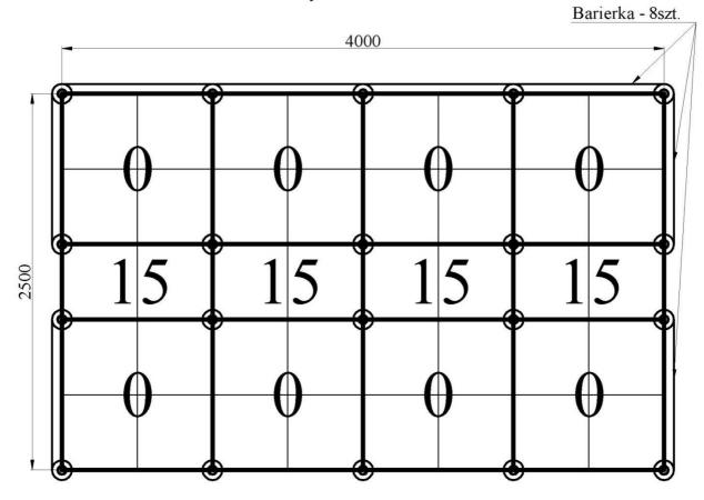
Schemat montażu stelaża SW-4x2,5 Assembly plan of steel galvanized mat grid SW-4x2,5
